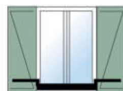
Appui de fenêtre (fixation basse)
