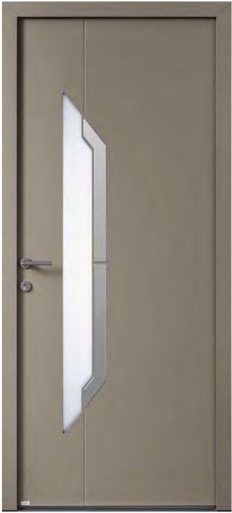
LINE 5 Triple vitrage feuilleté sablé classe 2. Design rainuré 2 faces identiques, et décor affleurant ton inox face extérieure uniquement. Gris perle 2800 texturé face extérieure, blanc 9016 face intérieure. Ud : 1.0
