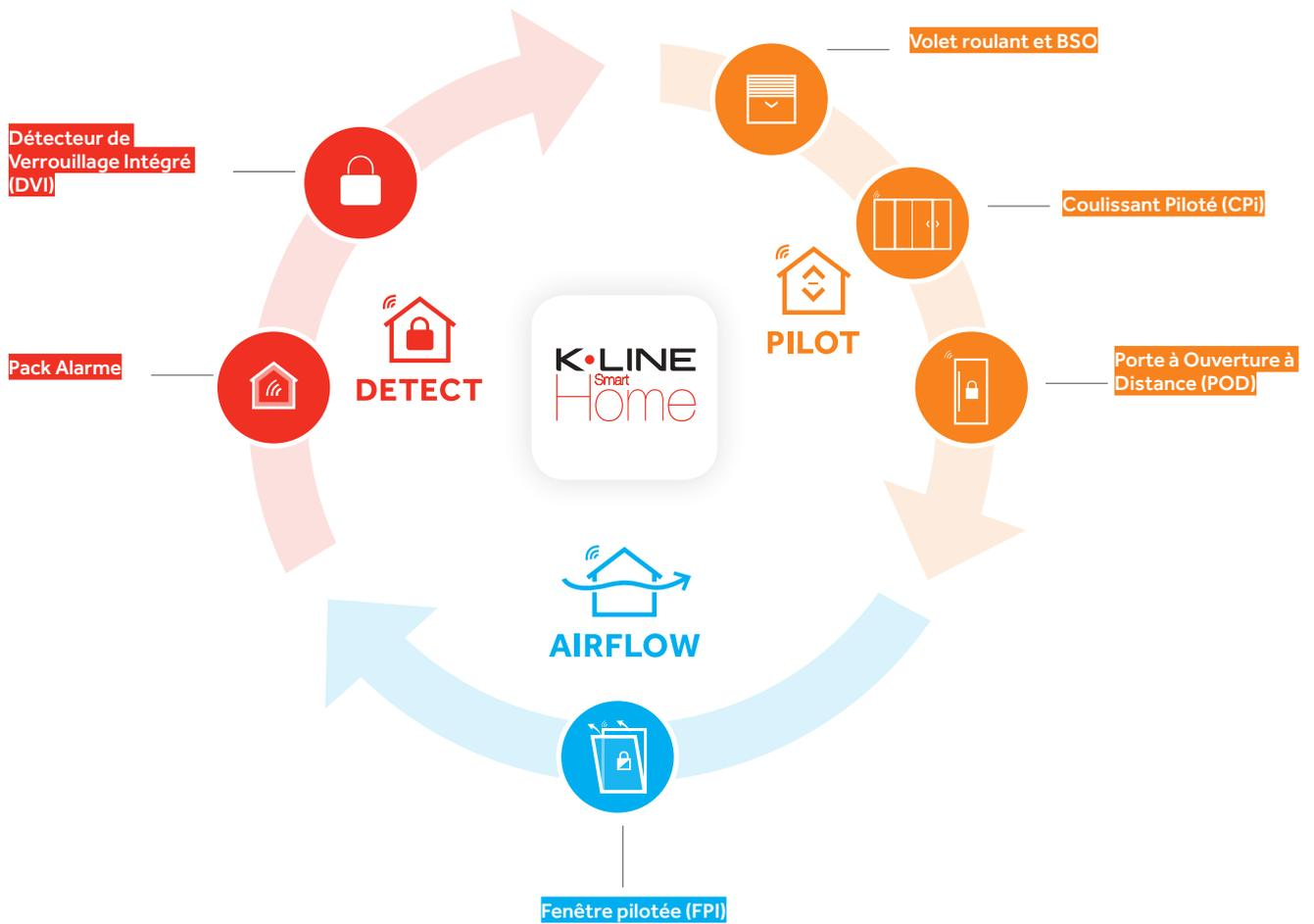
Le **DVI** ou **DÉTECTEUR DE VERROUILLAGE INTÉGRÉ** est un capteur radio, sans fil, qui permet à chaque menuiserie équipée, frappe, coulissant et porte d'entrée, d'informer sur son état en temps réel : verrouillé ou non.
